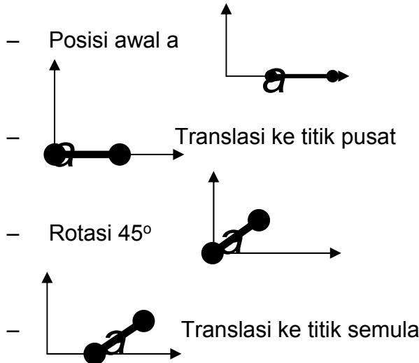
$$\begin{bmatrix} 1 & 0 & -3 \\ 0 & 1 & 0 \\ 0 & 0 & 1 \end{bmatrix} \begin{bmatrix} \cos(45) & -\sin(45) & 0 \\ \sin(45) & \cos(45) & 0 \\ 0 & 0 & 1 \end{bmatrix} \begin{bmatrix} 1 & 0 & 3 \\ 0 & 1 & 0 \\ 0 & 0 & 1 \end{bmatrix} = \begin{bmatrix} a'_x \\ a'_y \\ 1 \end{bmatrix}$$
